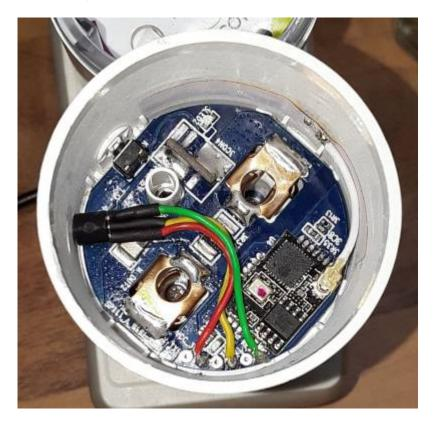
GND an GND, VCC an VCC und Data an TX
