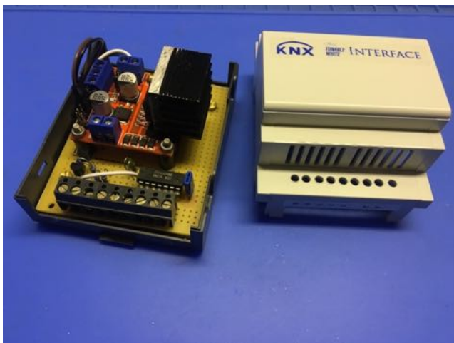
Einbau in Reiheneinbaugeschäft
